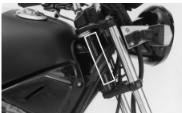
(1) O número de série do chassi está gravado no lado esquerdo do tubo da coluna de direção.
