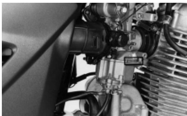
(3) O número de identificação do carburador está localizado no lado direito do corpo do carburador.
